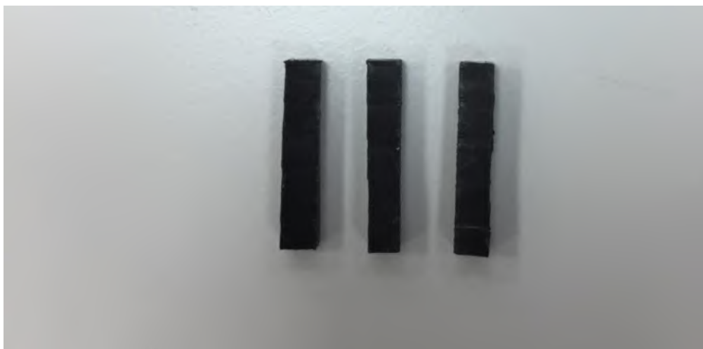
Рис. 79 – Образцы для проведения измерений КЛТР
