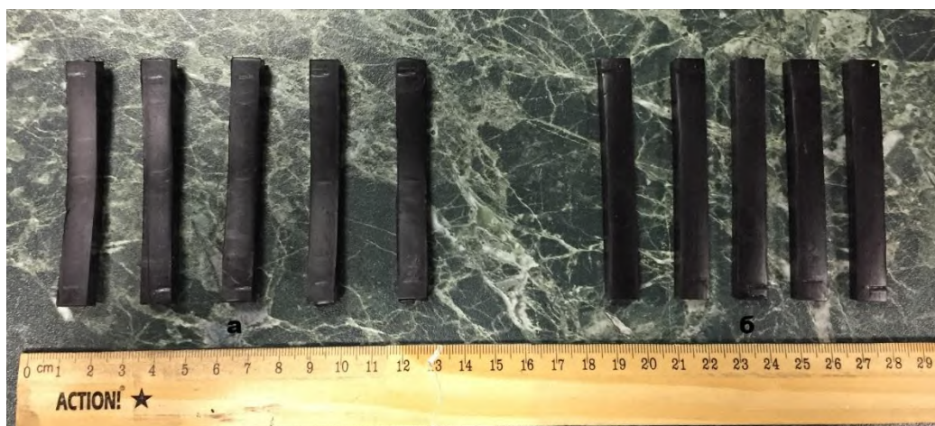
Рис. 42 – Стандартные образцы для испытаний на трехточечный изгиб. (а) после испытаний, (б) до испытаний
