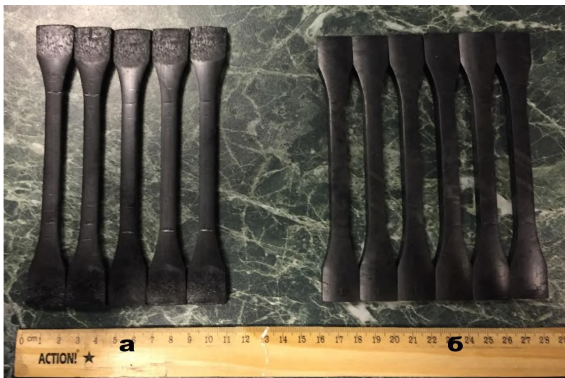
Рис. 36 – Стандартные образцы для испытаний на растяжение. (а) после испытаний, (б) до испытаний
