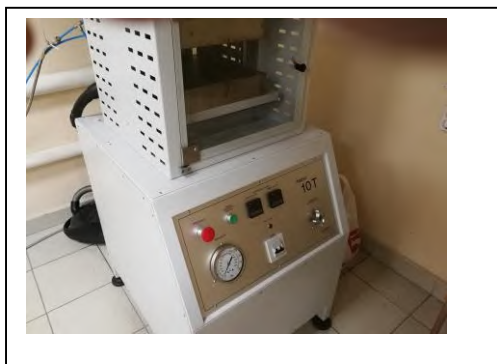
Рис. 4 Пресс. Образец помещался внутрь 10-ти тонного пресса и незначительно сдавливался
