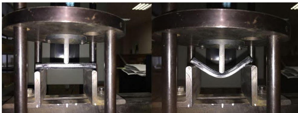
Рис. 40 – Общий вид испытательной оснастки на трехточечный изгиб
