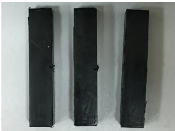
Рис. 46 – Стандартные образцы для испытаний на ударную вязкость по Изоду
