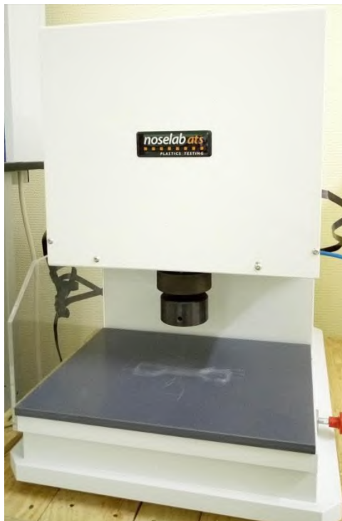
Рис. 33 – Общий вид пневматического прессы Noselab ATS.
