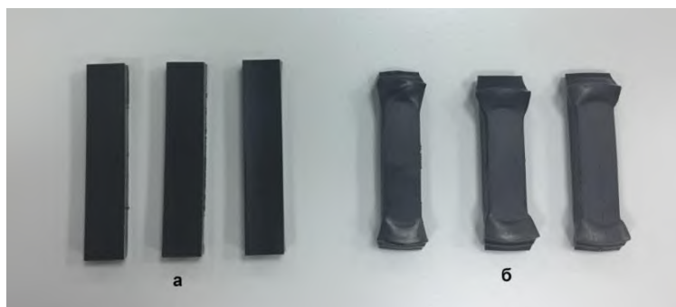
Рис. 84 – Образцы для определения зависимости модуля упругости от температуры при изгибе методом ДМА
