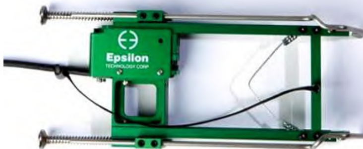
Рис. 37 – Общий вид экстензометра для измерения продольной деформации Epsilon 3542-050M-100-ST.
